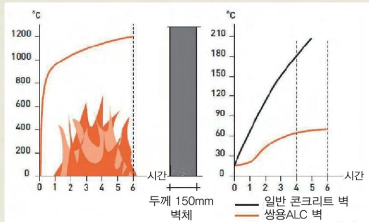
위 자료는 벽체 두께 150mm의 ALC 벽체와 대표적인 내화 건축자재인 콘크리트 벽체의 내화성능을 비교한 것으로서, 화재발생 6시간 경과 후 화재의 온도가 1,200도 까지 상승했을 때 화재로부터 콘크리트벽체로 격리된 실의 온도는 목재의 발화온도인 260°C 이상 올라가 화재가 확산된다. 반면에 ALC벽체로 격리된 실의 온도는 68°C 정도로 발화온도에 못 미쳐 화재의 확산을 차단할 수 있다(아래 그림 참조).
