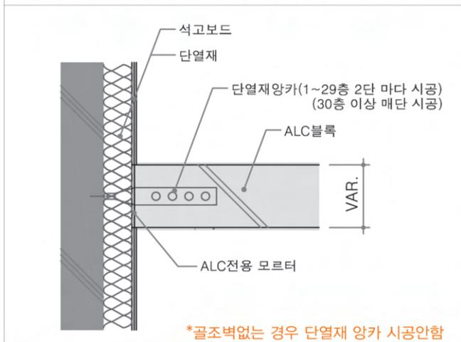
벽체 이질재 접합부 평면상세도 (단열재 접합부)
